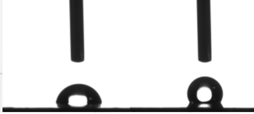
Şekil 3. Kaplama öncesi (a) ve sonrası (b) alüminyum yüzeylerde su temas açısı görüntüleri
