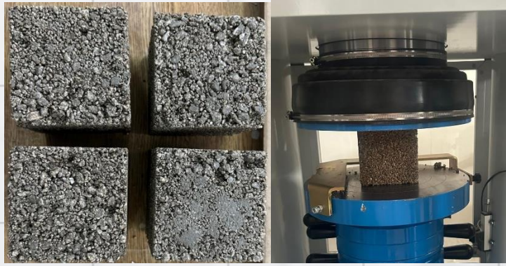
Şekil 1. Numuneler ve basınç dayanım deneyleri
